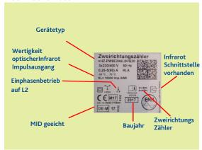
Energieanzeige in kWh (Zählwerkstand) 1.8.0 und 2.8.0 alle 10 sek. abwechselnd 6 Stellen, keine Nachkommastelle Die Phasen L1, L2 und L3 liegen an, beim Wechselstromanschluß wird nur L2 angezeigt.
