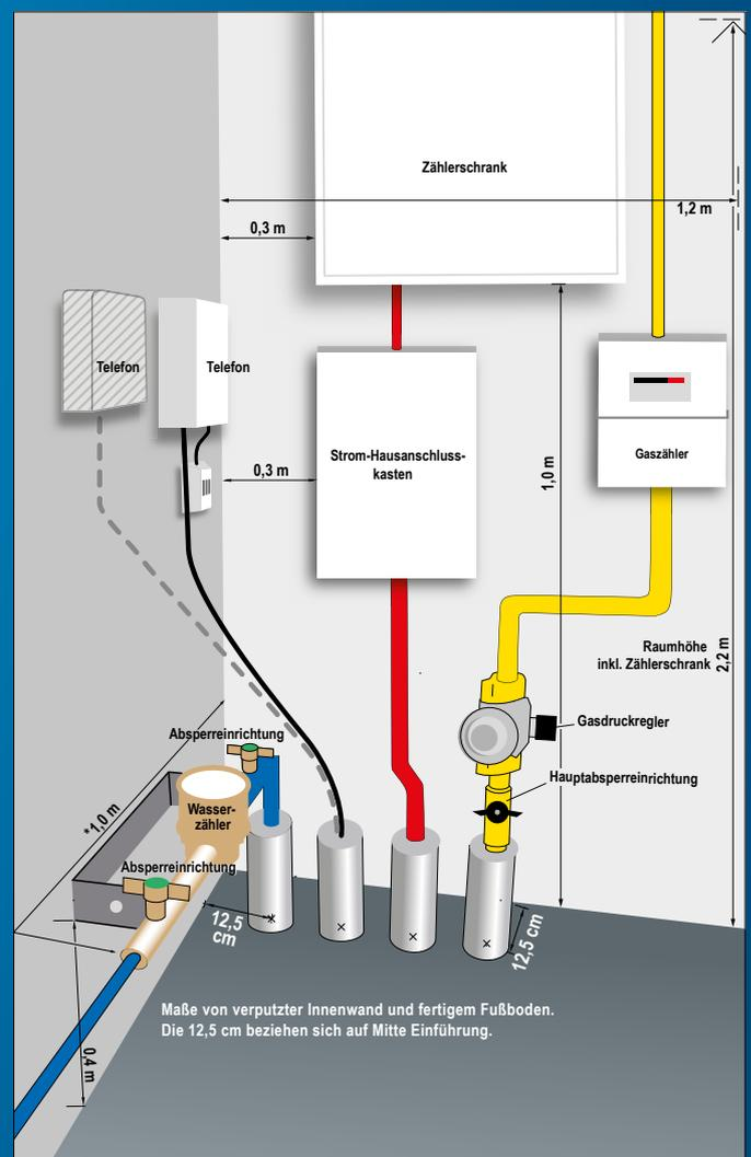
Maße von verputzter Innenwand und fertigem Fußboden.
