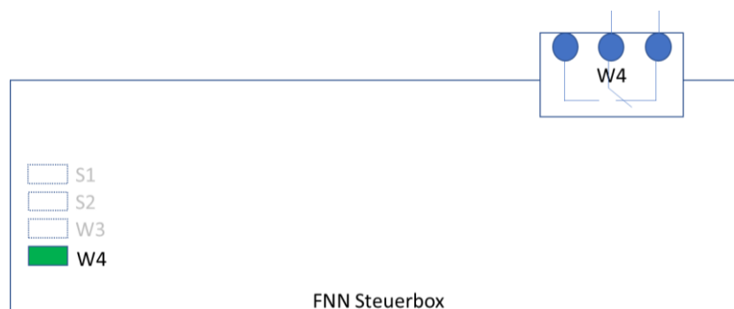
Abbildung 10: Darstellung der Schalterstellung für aktive Regelung der §14a Anlage mittels Relais (LED W4 leuchtet grün)
