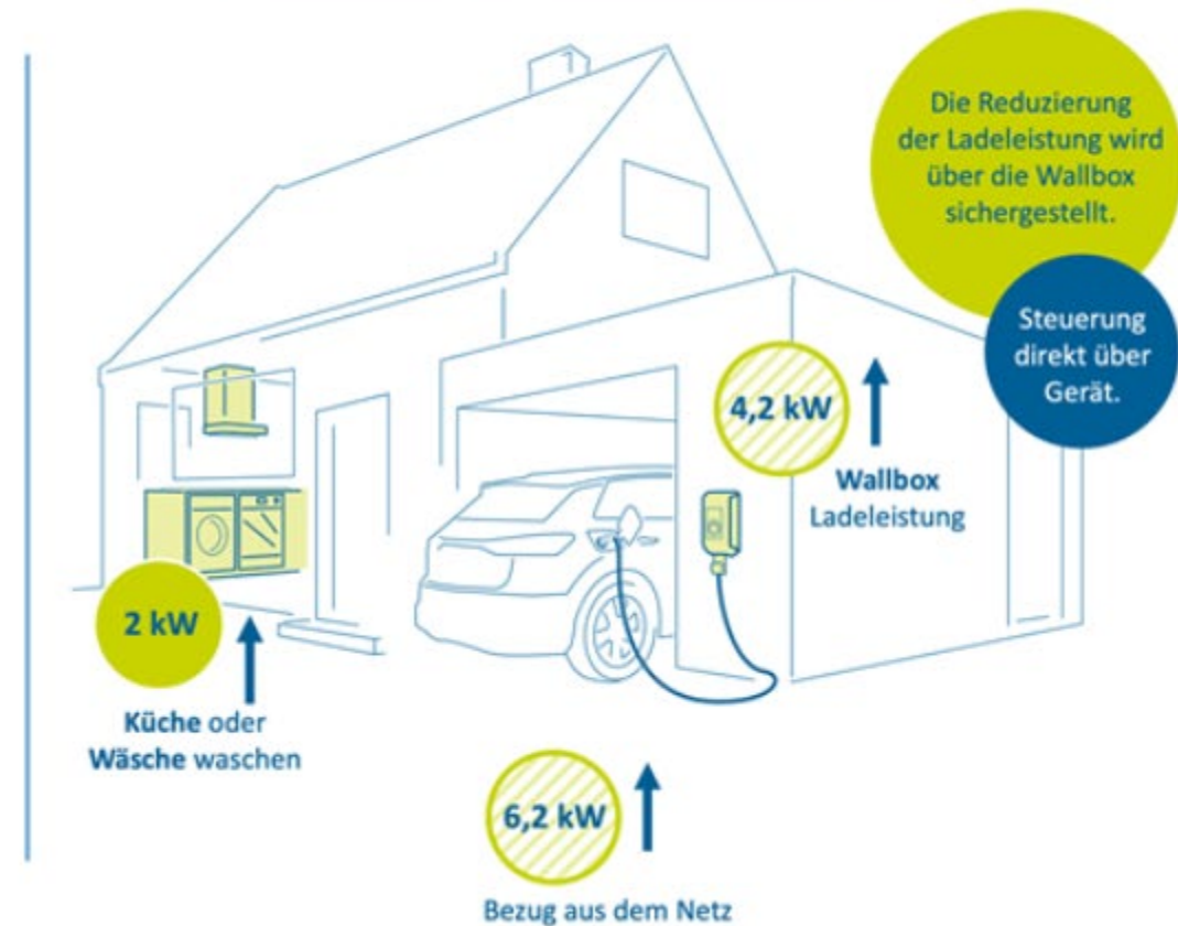
MIT Steuerung der Verbrauchseinrichtungen
