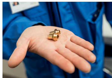
Gasgeräte, anpassbar mit Material (im Regelfall Düsentausch).
