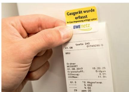
Die Messung wird dokumentiert und mit einem Aufkleber am Gerät befestigt.
